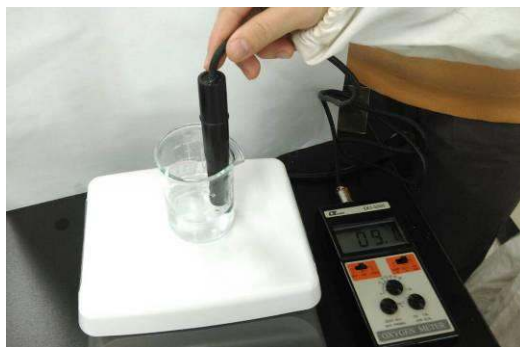
圖 11 利用溶氧計偵測水中溶氧量變化
