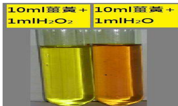
圖七：薑黃溶液加入 \text{H}_2\text{O}_{2(aq)} 與對照組的比較
