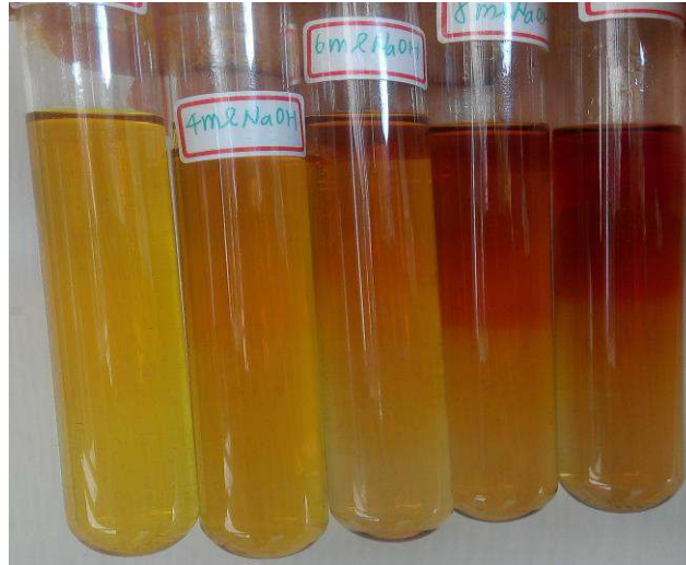
圖二十四：薑黃溶液加入氫氧化鈉後照光 24hr
