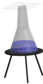
▲ 圖 4.7 電解液與洋菜粉混合加熱示意圖
