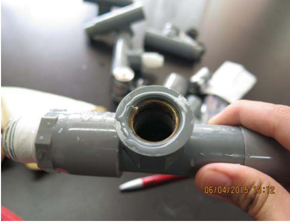
圖三 由此孔插入導電度計
