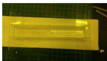
圖二十二： n=1.48 硬化時材料情形(算透明，但表面無甚平整) 圖二十三： n=1.51 硬化時材料情形(黃化，表面極不平整)
