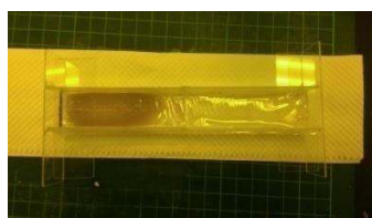
圖二十二： n=1.48 硬化時材料情形(算透明，但表面無甚平整) 圖二十三： n=1.51 硬化時材料情形(黃化，表面極不平整)
