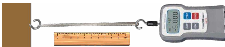
圖四、彈性係數測量實驗示意圖(左為固定端，右為拉力計端)
