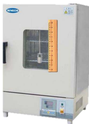
圖五、彈性係數對溫度實驗示意圖 (烘箱中為人造肌肉下掛定重重物)
