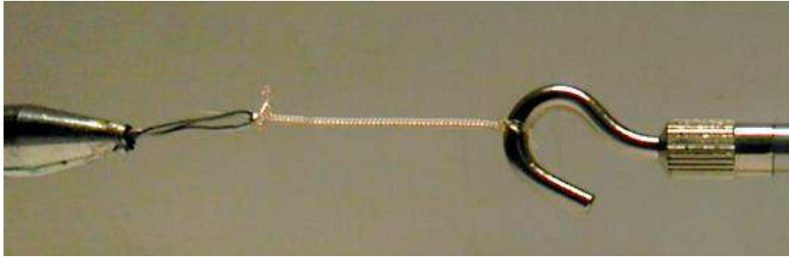
圖一、拉力實驗圖(左為馬達端，右為拉力計端)
