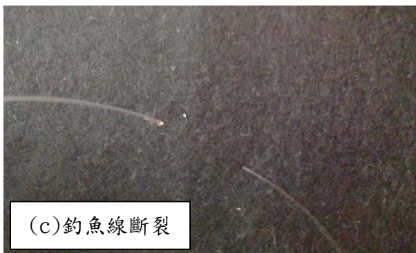
圖八、不同應力下的釣魚線結構結果圖 (a)拉力太小(b)拉力適當(c)拉力過大
