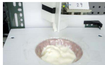
圖六：裝有非牛頓流體的金屬圓盤置於喇叭上 圖七：裝有非牛頓流體的喇叭模擬器
