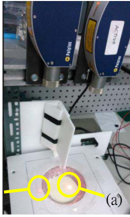
圖十四：雙頻道雷射都卜勒振動計 裝置圖
