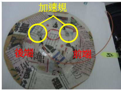
圖十一：裝設在喇叭模擬器底部的兩個加速規
