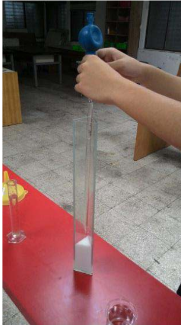
圖(10) 分度吸量管沿管壁注入純水
