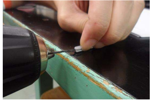
圖 23：用電鑽將樂高積木軸心鑽孔
