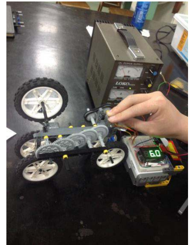
圖 24：使用自製轉速計測量轉速
