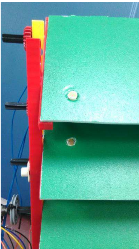
圖三、葉片上裝設光敏電阻
