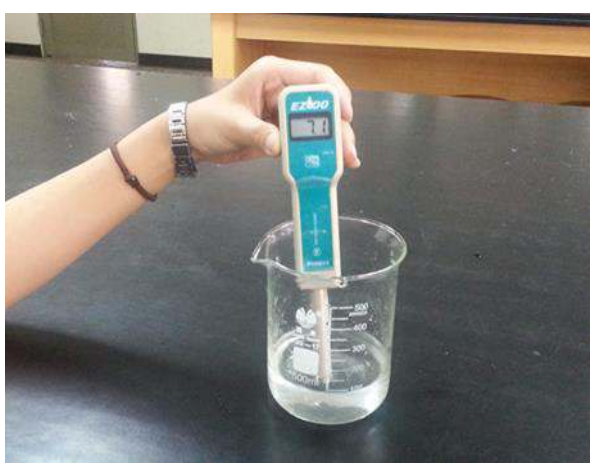
(23) 酸性液過濾後 pH 值測試→7.1
