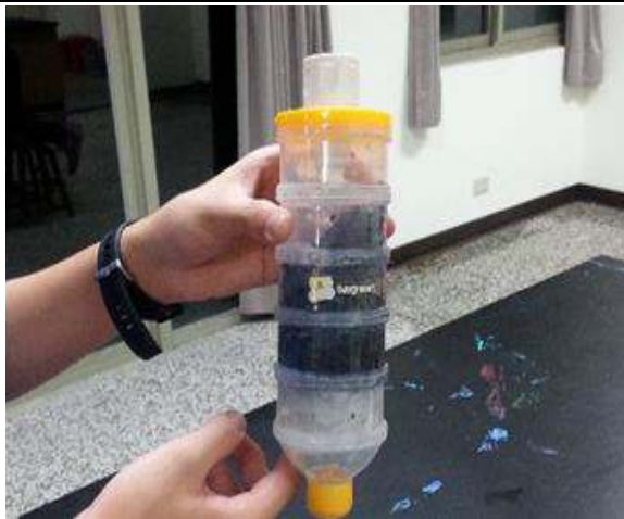
(11) 裝上蓮蓬頭延長接頭組(有水龍頭時)
