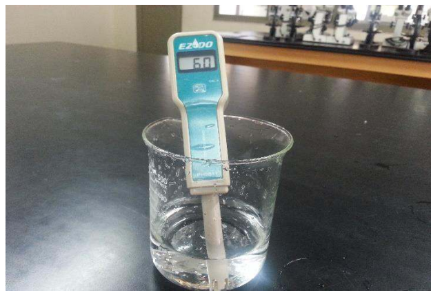
(27) 酸性液過濾後 pH 值測試→6.0
