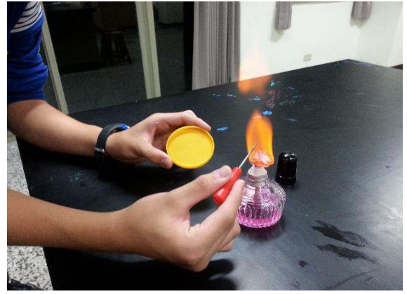
(2) 將小鑽子加熱準備頂蓋中間鑽洞
