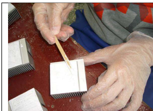
圖 3-6 在散熱鰭片上導熱膏
