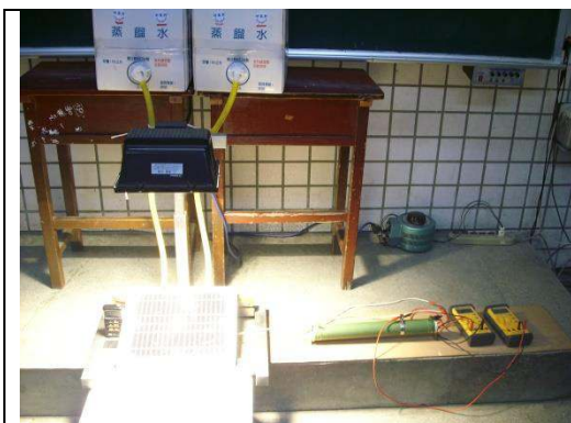
圖 3-8 正面水冷裝置
