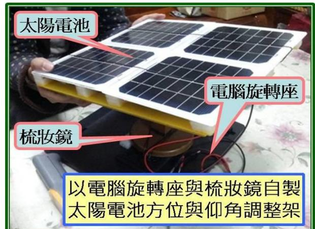
圖 15 自製太陽電池方位與仰角調整架
