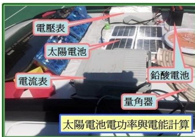
圖 25-2 太陽電池電功率與電能計算實驗照片
