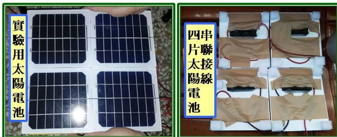
圖 12 (左)實驗用太陽電池 (右)四片太陽電池串連接線
