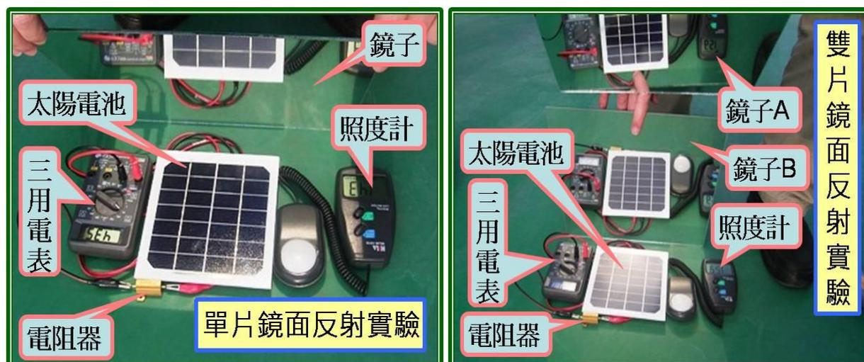
圖 20 最佳鏡面方位與仰角實驗~單片鏡子 圖 21 最佳鏡面方位與仰角實驗~雙片鏡子
