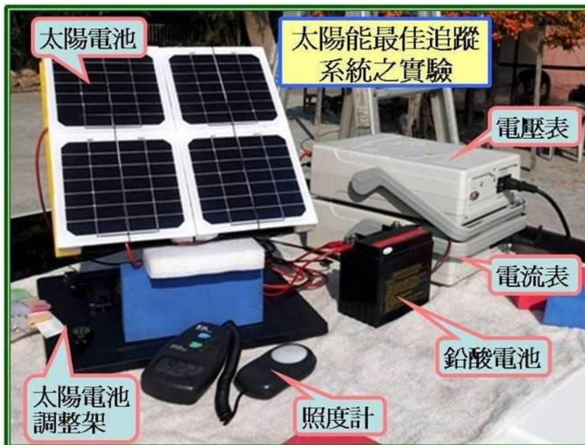
圖 27-2 動態方位與仰角在載具儲能之實驗照片
