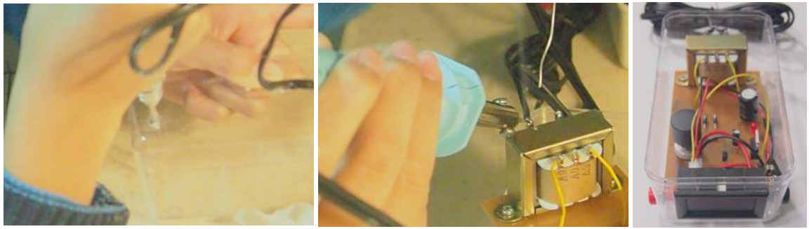
(a) 電源供應器之盒體加工 (b) 電源供應器之變壓器銲接 (c) 電源供應器
