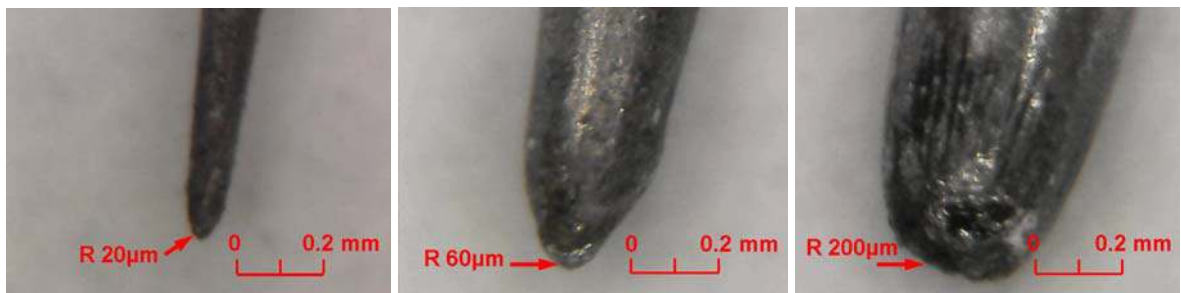
(a) 頂端半徑 20 \mu\text{m} 針尖 (b) 頂端半徑 60 \mu\text{m} 針尖 (c) 頂端半徑 200 \mu\text{m} 針尖
