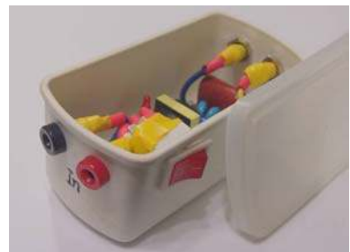
(f) 完成倍壓線路組成品
