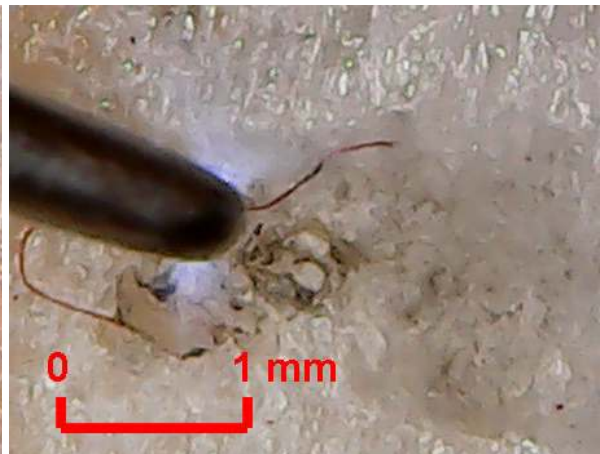
圖 20 3 號雙電池串聯經倍壓輸出 2300V、 1.58mA，以 R200 \mu m 針尖電擊洋蔥表面
