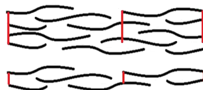
圖三十八、厚度對易破度的影響原理
