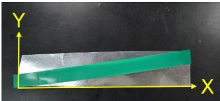
而緞帶、剪紙、裁紙……等會呈螺旋狀，主要也是因為受力方向是斜的、也就有水平和垂直兩方向的分力，兩不同方向的力拉扯就會變成螺旋狀。若有兩組力，螺旋效果更好。而兩面材質不同的鋁箔紙遇熱會呈螺旋狀，是因為金屬有熱脹冷縮的性質，當鋁箔紙並非左右對稱時，左右膨脹長度不同，向短邊捲曲，使得紙張變成螺旋。而果莢的情形不是熱脹，而是乾縮（乾燥總長度縮短），長邊縮短較多，所以果莢乾燥後，由內往外，往長邊捲。
