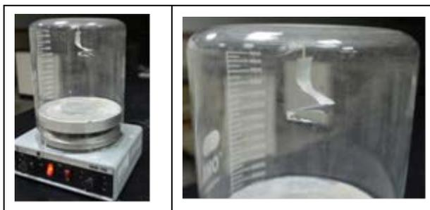
2.烘箱方便又受熱均勻，但不透明，無法立即看到變化。利用這個方法製造的簡易的透明烘箱，雖然熱不夠均勻，但可以立即看到紙張的螺旋轉變。
