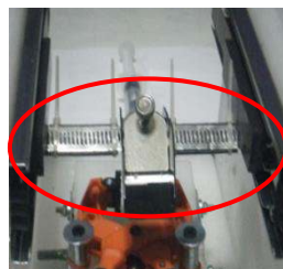
圖三十三、平面刀座的改良方式：管束當作支撐，再以束線帶固定磁條及鐵條。
