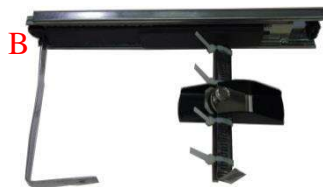
圖三十二、第三代刀座製作。A、保持抽屜軌道原有功能；B、使用了兩層磁鐵來固定刀座。
