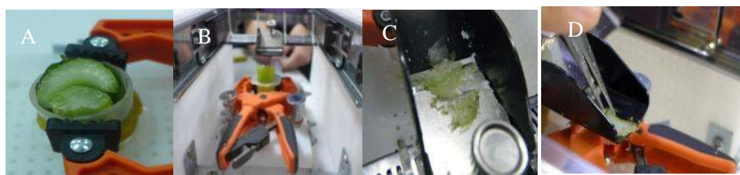
圖二十七、第三代切片機直接切片操作方式：A、將樣本放入針筒；B、將套有橡皮筋的針筒用小型快速夾具固定；C、將刀片來回推動切取樣本；D、以鑷子取樣(葉薄片)。
