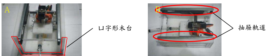
圖十五、第三代基座架設示意圖：A 為側面圖；B 為正面圖。
