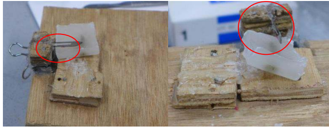
圖二十二、第一代設計缺點：力道不足，蠟塊無法切割。
