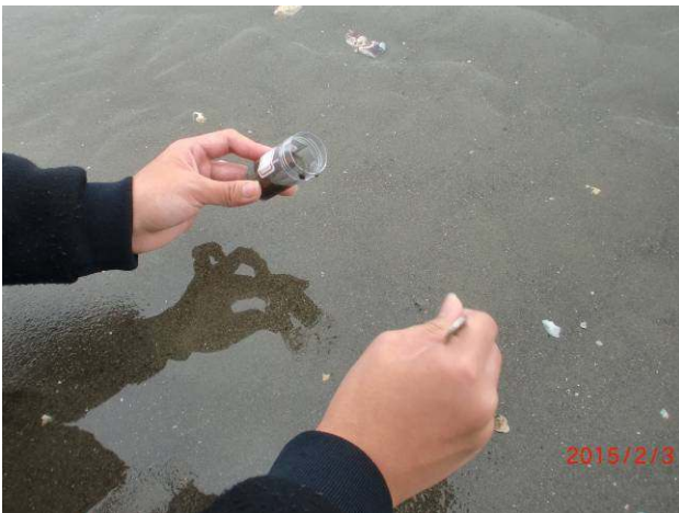
圖二(左)、(右) 使用採樣瓶和採樣匙在採樣點進行沉積物和水樣本採樣。
