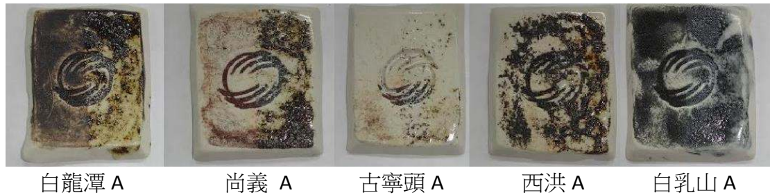
圖 10 各地點樣本 A 的氧化鈷粉末燒製陶片結果
