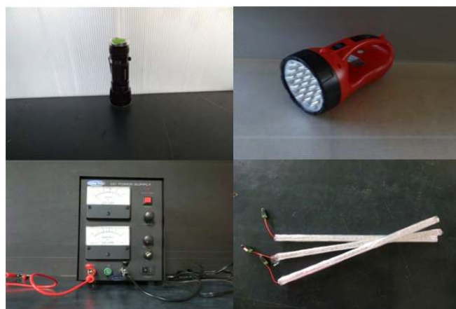
圖四、左上、右上圖分別是手電筒和探照燈，可以拿來照射在水槽，可以拍攝到更清楚的照片。左下圖是直流電源供應器，可以調整風扇風速。右下圖是燈條，可以照亮水槽。
