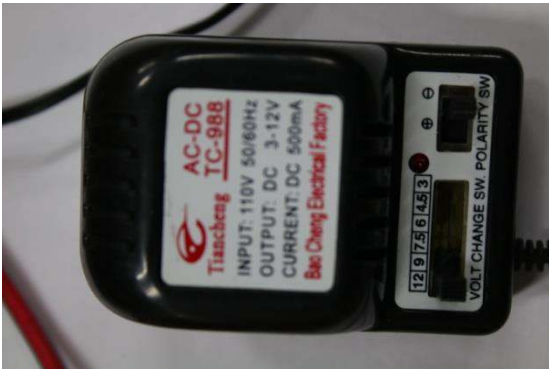
圖6 可調電壓的變壓器
