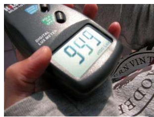
圖 25 測量戶外光度
