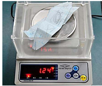
圖 7b 剪下方格紙，稱重換算面積
