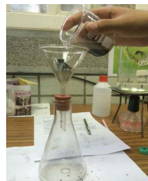
圖九、利用透析膜過濾水解黑棘蟻( P.dives )蟻絲。
