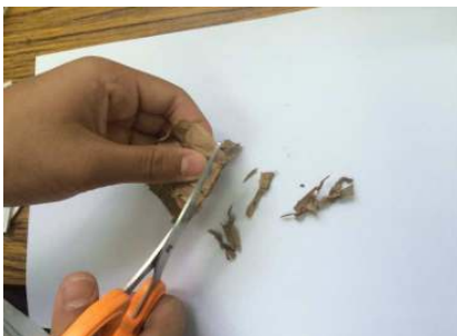
圖七、將較大的黑棘蟻蟻絲蛋白膜剪成小塊的蟻絲條。
