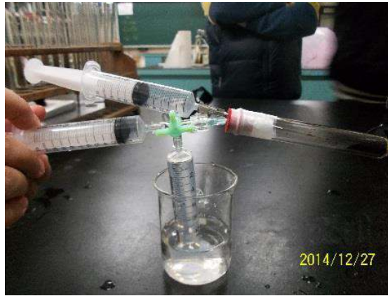
圖四-12 設置一個裝置來測定空氣中的含氧量
