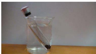
圖四-18 讓試管溫度降至室溫
