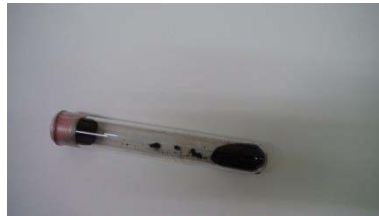
圖四-15 由日本製林純藥草酸亞鐵加熱製成的奈米鐵粉
