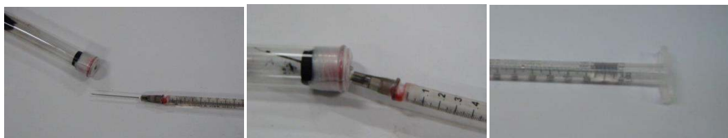
圖四-17 讓試管內的氣體壓力與大氣壓力確認保持平衡
