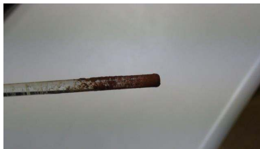
圖四-3 氧化鐵黑色粉末可被強力磁鐵隔試管吸引，玻璃棒上面深褐色粉末是氧化鐵
