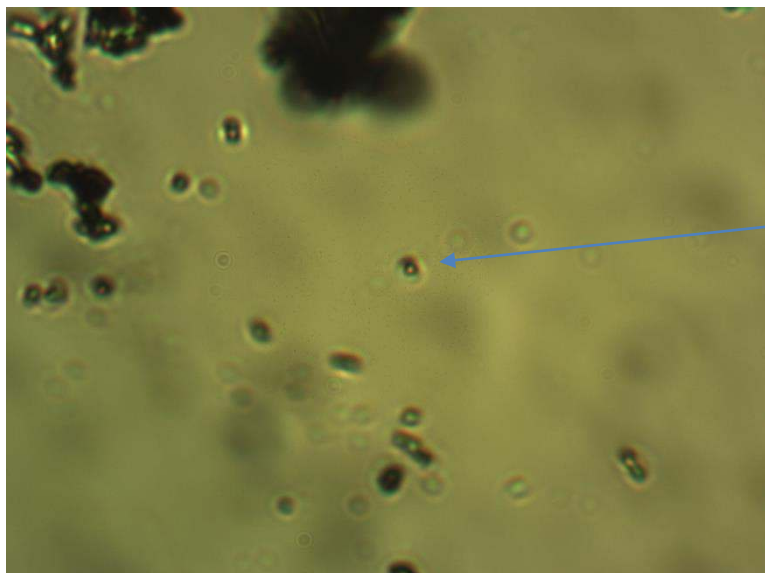
圖四-9 鐵粉在高倍率的正立晶像顯微鏡下的照片
