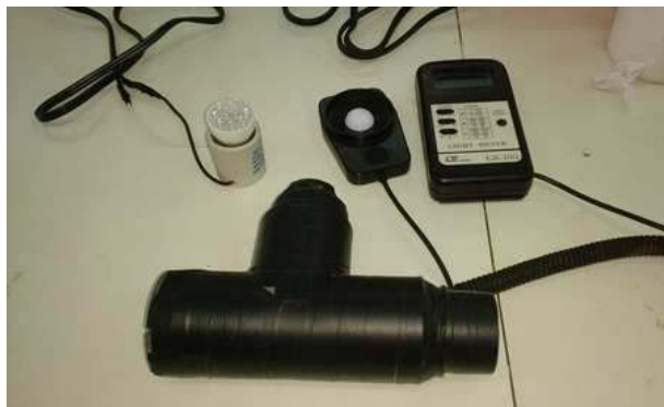
圖 1、以水電材料製作分析儀器。
