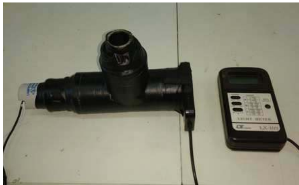
圖 2、自製簡易版的分光光度計。
