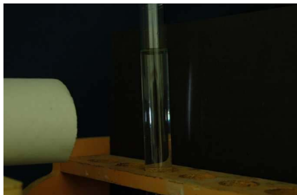
圖 4、(左)塑膠管中放入雙層隙縫當光柵；(右)通過試管後，不再有暈散的現象。
