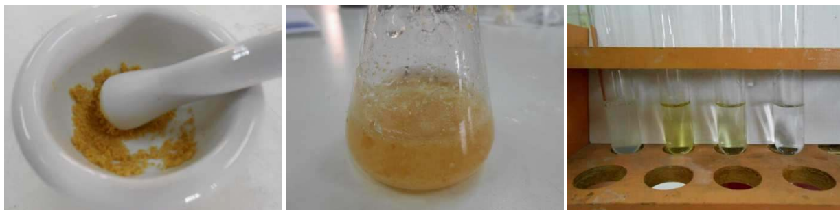
圖 23、將油條搗碎、加水溶出、高速離心後，抽出上層澄清液的過程。
