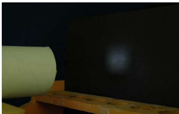
圖 3、(左)塑膠管中放入正方形開口的光柵；(右)通過試管後，光線會暈散開來。
