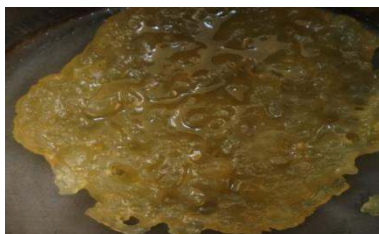
基礎油析出，潤滑脂變硬
