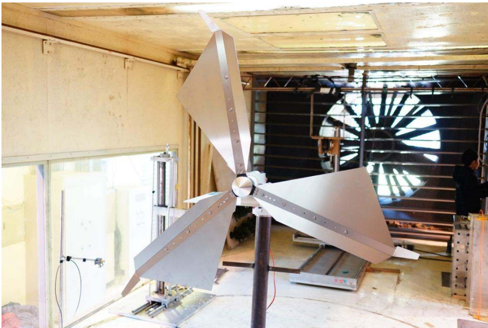
圖 5 CG 模式配合高效葉片於大型風洞實驗
