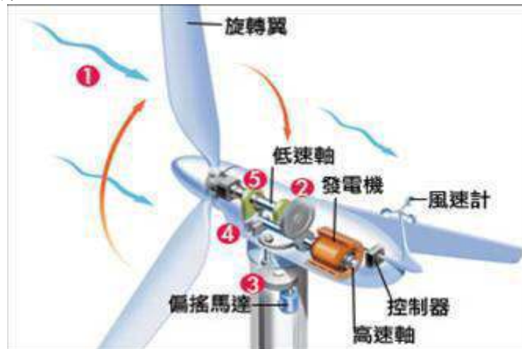
附圖 2 水平軸風力發電內部構造示意圖(圖片引用自崑山科技大學 http://rein56.myweb.hinet.net/Wind%20Energy.htm )
