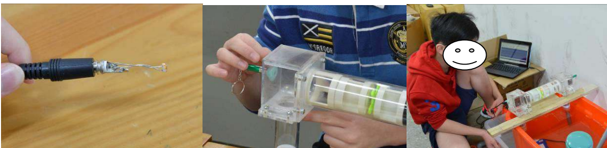
圖 5 自製音效卡轉速計
