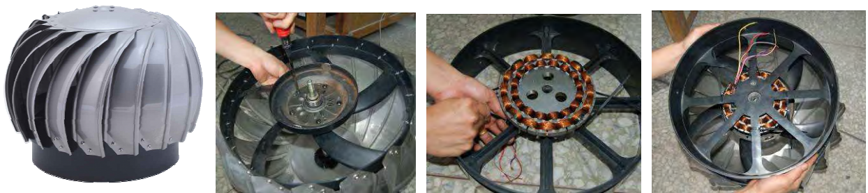
我們將通風球拆開，在葉片上固定轉盤，在底座用束線固定線圈組，最後組裝完成。
