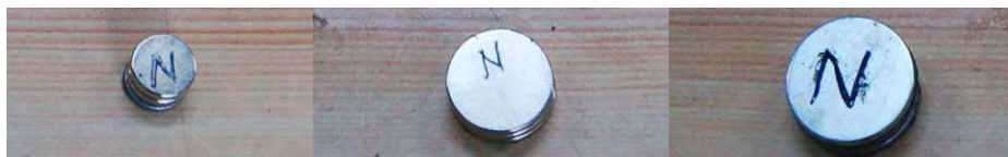
三種不同尺寸的磁鐵，由左至右磁鐵直徑分別為15mm，24mm及30mm
