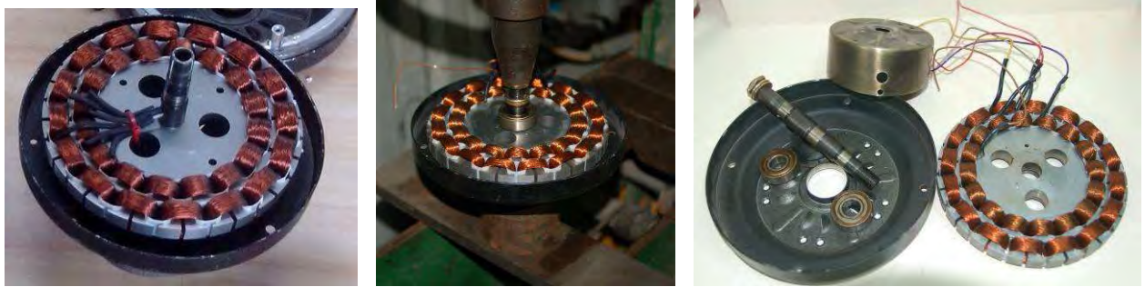
線圈組件的轉軸用壓床取出，要在通風球的轉軸裝上轉盤和線圈。
