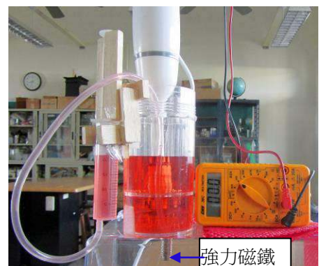
圖十二：自製流體壓力觀測器裝置
