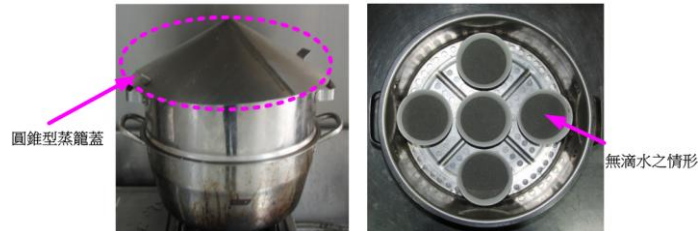
圖 10 採用「圓錐型蒸籠蓋」沙子上面沒有滴水情形
