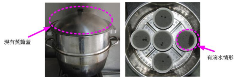
圖 9 採用「現有蒸籠蓋」沙子上有明顯的滴水痕跡
