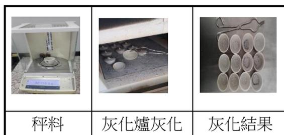
圖 10 灰分測定實驗過程
