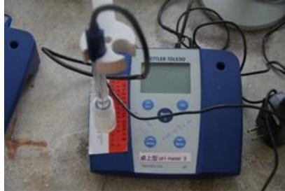
圖二、酸鹼度計 (METTLER 公司, EL-20)
