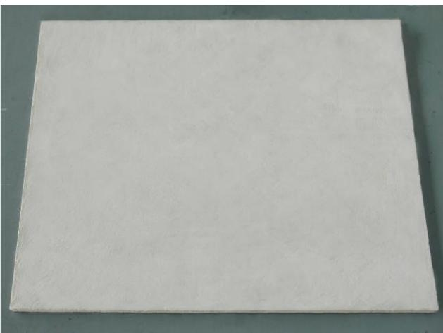
圖 7 聚合物複合建材鑄造地磚 (灰石質感)
