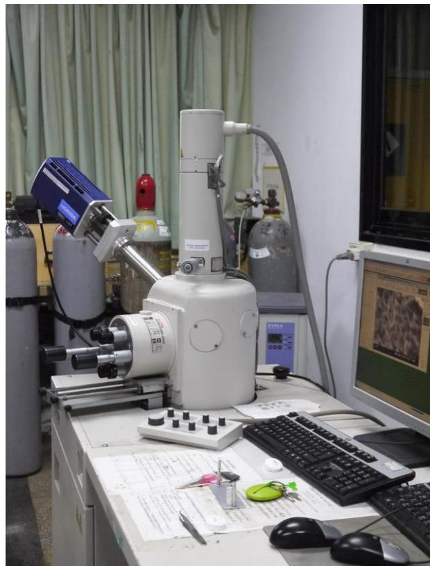
圖 13 掃瞄式電子顯微鏡
