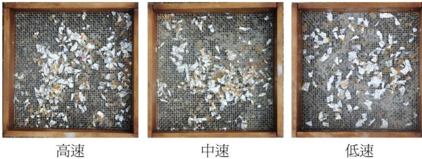
圖9 第一道過濾留下的殘渣（聚乙烯附著紙、鋁箔）
