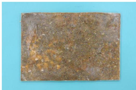
圖 34 鐵板加熱加壓製密集板
