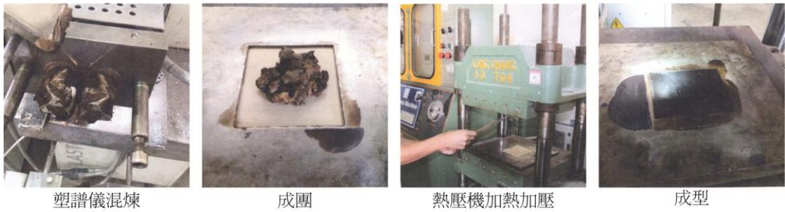
圖 30 將 70% 殘渣加高密度的聚乙烯加熱加壓
