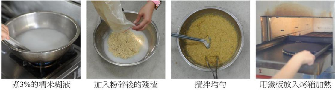
圖 29 以 3% 糯米糊液放入鐵板加熱加壓
