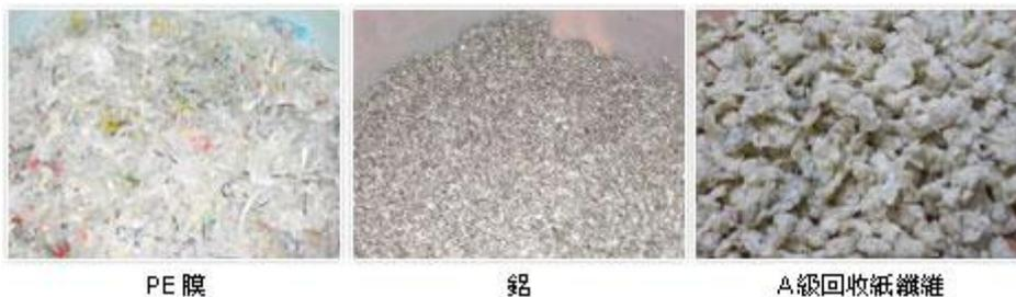
圖 26 鋁箔包可回收 PE 膜、鋁、紙纖維<sup>(5)</sup>
