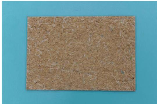
圖 32 加 3% 糯米糊液製密集板
