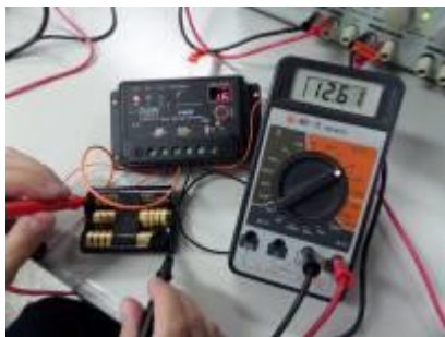
圖 7 鋰電池充飽電壓為 12.6V
