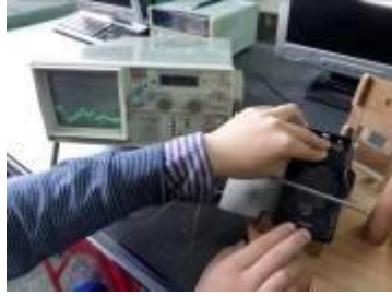
圖 52 頻譜分析儀觀察周圍電磁波情形
