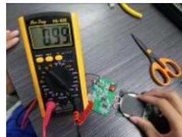
圖 21 觀察接收模組輸出電流量
