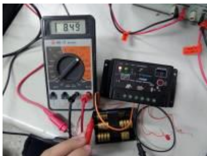
圖 8 8.5V 負載端停止供電
