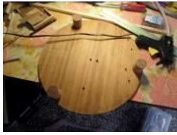
10. 安裝底座支撐腳
