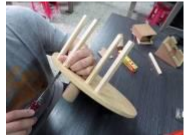
12. 安裝倒凸型收納支撐架
