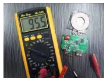
圖 23 觀察發射模組待機電流量
