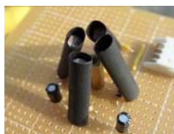
圖 48 利用熱縮套管產生陰影法
