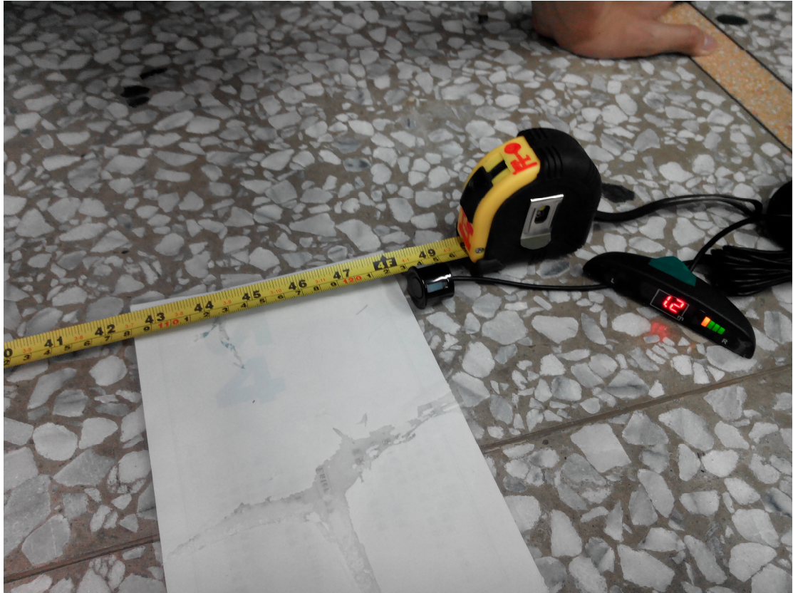
圖 19 超音波測距實驗圖
