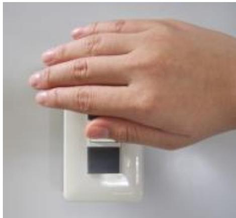
手部向上滑動後，向下遮蔽上方感測器，可改變電燈點亮的盞數
