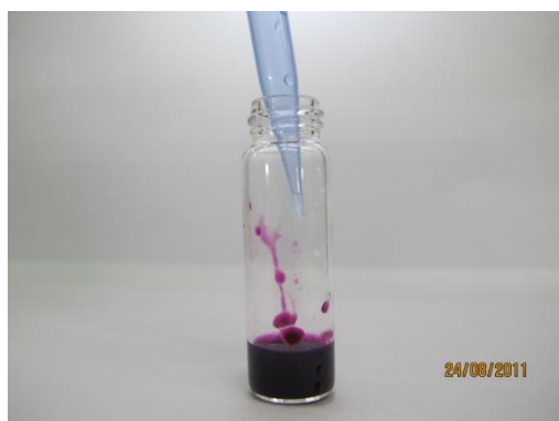
圖 5.1 待測酒液添加至 A 溶液檢測瓶，5 分鐘後顏色由紫紅色轉為褐色
