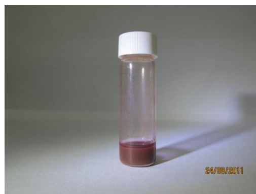
圖 5.1 待測酒液添加至 A 溶液檢測瓶，5 分鐘後顏色由紫紅色轉為褐色
