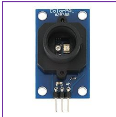
圖 3.9 ColorPAL 顏色感測辨識器模組圖
