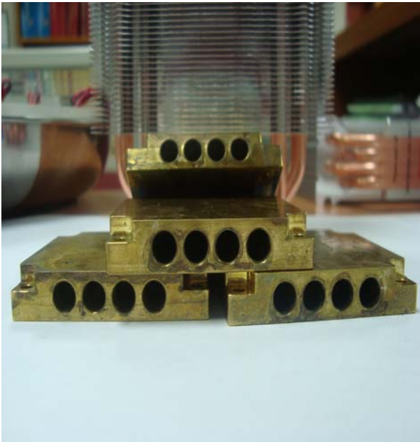
圖 1-1. 銅板散熱器鑽孔
