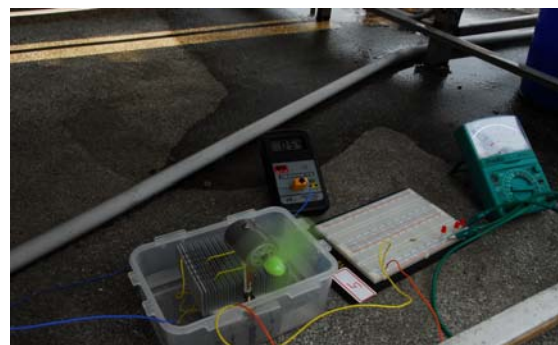
〈圖 21〉太陽能熱水器讓致冷晶片發電運轉
