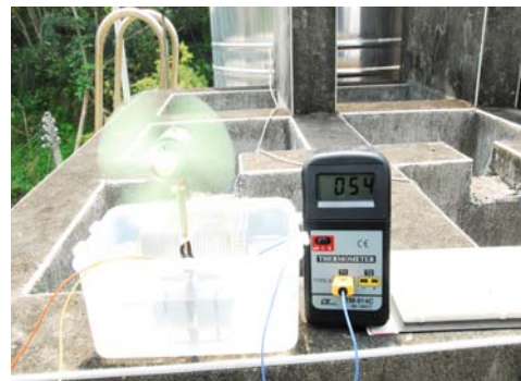
〈圖 5〉溫度計測出水溫 54^{\circ}\text{C} 就能夠高速運轉的風扇
