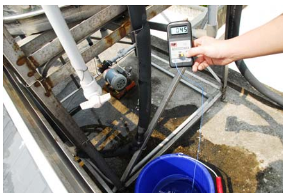
〈圖27〉太陽能熱水塔冷熱循環之水溫測試 上層水溫67°C，下層水溫55°C
