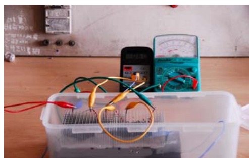
〈圖 19〉致冷晶片串聯 電壓較高
