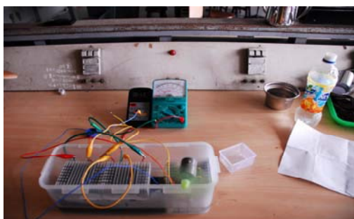
〈圖 18〉致冷晶片並聯 電壓較低
