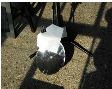
〈圖 14〉碟式反射讓紙張加熱燒
