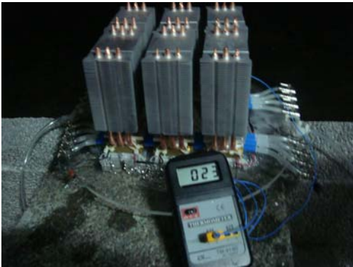
〈圖 21c〉夜間時散熱片的溫度為 23 度實際量測照片
