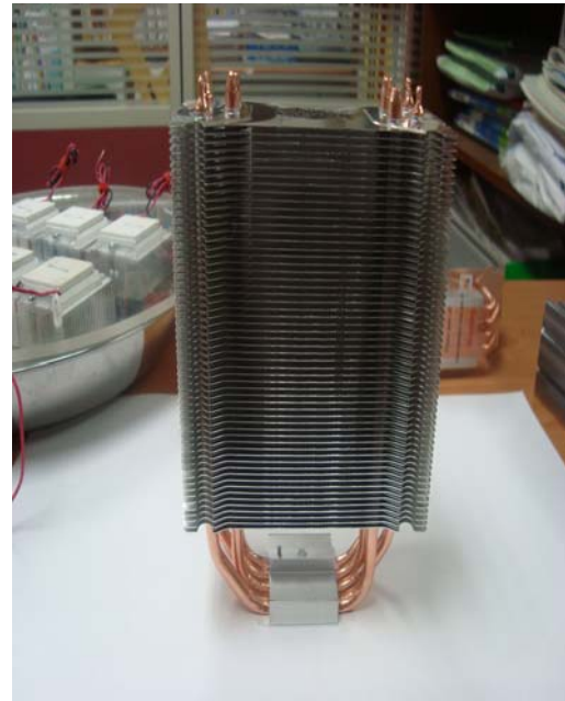
圖 1-2. 新式 CPU 專用型散熱器
