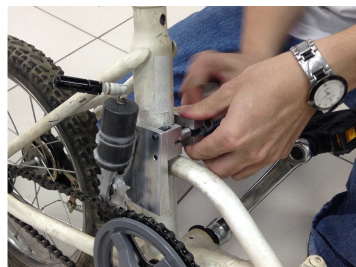
圖 7-8 快拆機構安裝測試(二)
