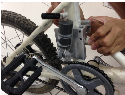
圖 7-7 快拆機構安裝測試(一)
