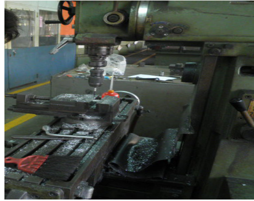
圖 4-8 銑床加工：活塞加工
