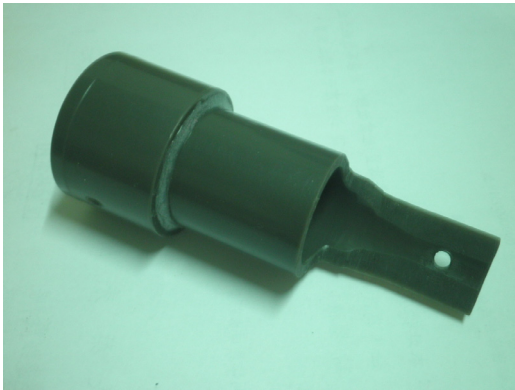
圖 6-1 氣壓缸本體製作
