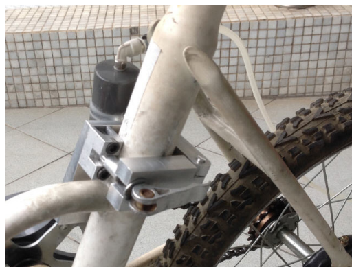
圖 7-5 充氣筒安裝於快拆機構上
