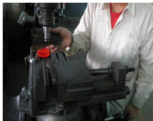
圖 6-4 修正 O-Ring 尺寸
