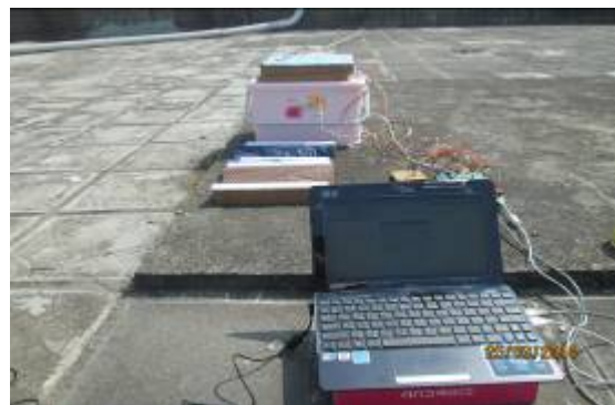
圖[5-8] 為應用電腦連線測試其溫度的情形
