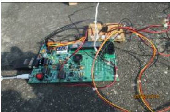
圖[5-7] PIC 測試之機板
