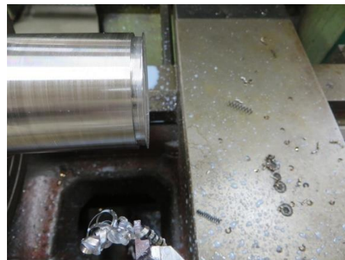
(b) 切槽刀加工表面狀況
