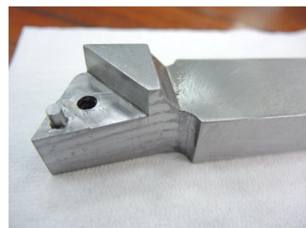
圖 26 外徑車刀架成品照
