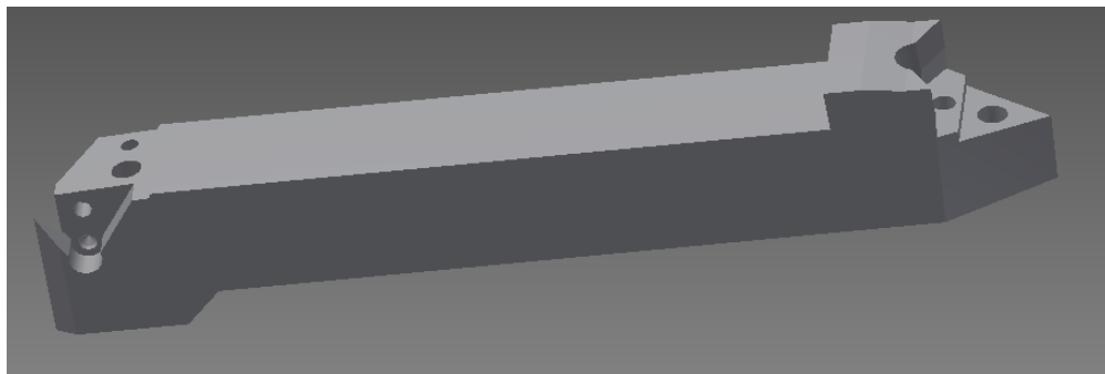
圖 31 倒角刀及外牙刀 3D 構想圖
