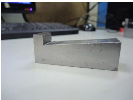
圖 17 切槽車刀架專用之輔助模具
