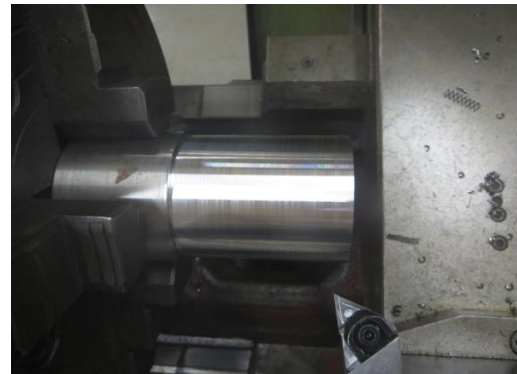
(d) 外徑車刀加工表面狀況
