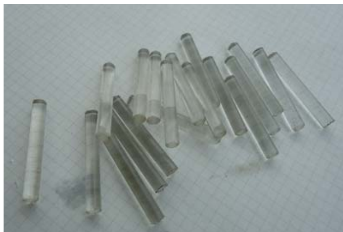
圖 32 以壓克力材質製作安全銷
