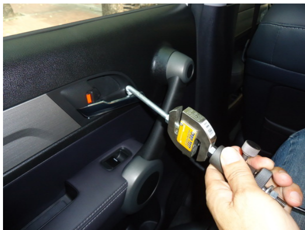
圖 38 測試開門拉力約為 1.8kg
