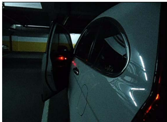
圖 72 實際裝置於汽車時警示燈閃爍情況
