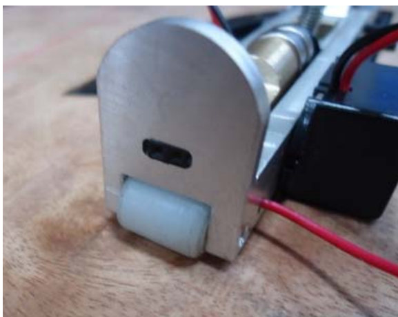
圖 66 安裝塑膠滾輪避免刮傷汽車內裝
