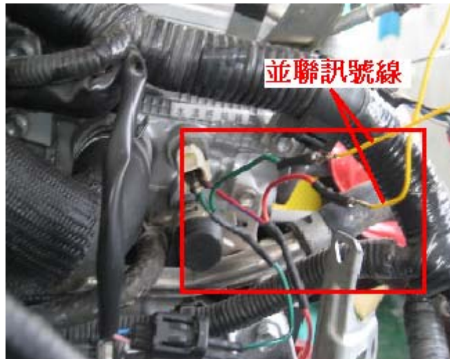
圖 16 水溫感知器並聯訊號線
