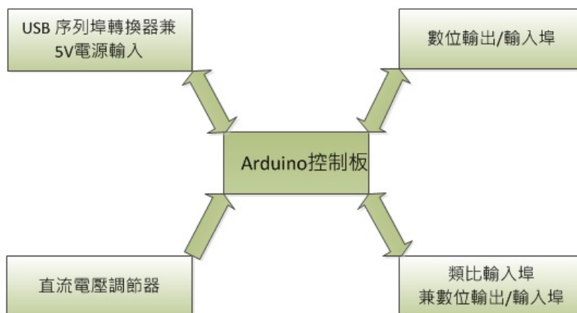
圖 20 微電腦板功能方塊結構圖
