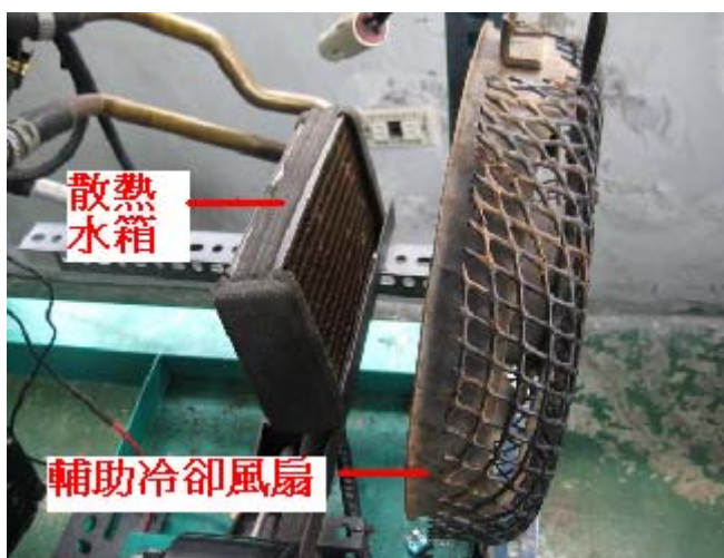
圖 14 輔助電動風扇與散熱水箱
