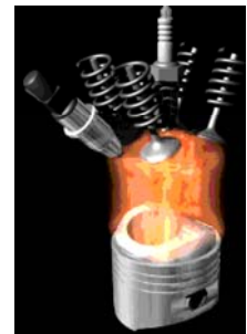
圖一 缸內直噴系統
