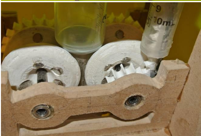
磁鐵滾輪控制磁性流體原
