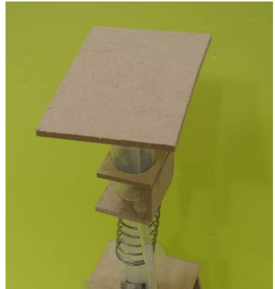
壓力感應(上)與避震器上端主體(下)
