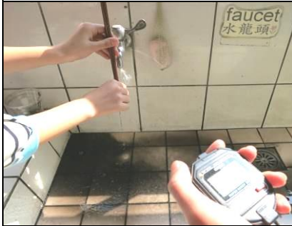
計時器計算相同時間的出水量
