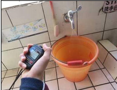
計時器計算相同時間的出水量
