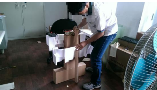
Step5-我們的自製風扇的底座是用保麗龍，及紙箱搭建而成的。
