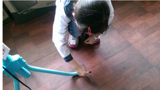
Step2-先將電風扇固定，確保以後的實驗環境都相同，所以畫線確定位置
